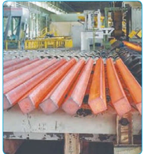
آهن در دمای بالا گداخته می‌شود
